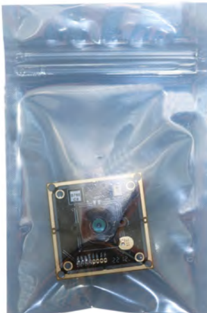
Scellez le plateau avec un sac antistatique
